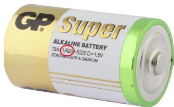
Щелочной элемент питания — марганцево-цинковый гальванический элемент питания. В качестве катода используется диоксид марганца, а в качестве анода — порошкообразный цинк. Электролитом является раствор щёлочи, обычно в виде пасты/геля гидроксида калия. На корпусе щелочных гальванических элементов ставится маркировка «LR».
